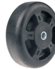
耐高温轮 采用特殊工程塑料模压而成，高强度、耐高温250°C和280°C。用于2系列。
