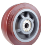
高科技聚氨酯(平边) 聚氨酯胶条用机械锁扣式注射于聚烯烃轮芯，用于4、6系列。
