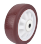
聚氨酯-防滑胎纹轮 聚氨酯胶条用机械锁扣式注射于聚烯烃轮芯，用于4和6系列。
