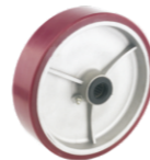
高科技铝芯聚氨酯 粘合压铸铝合金轮芯，8°轮芯有加强筋，轮面是超耐磨聚氨酯，适用于4、6、7系列。
