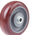
高科技聚氨酯 聚氨酯胶条用机械锁扣式注射于聚烯烃轮芯，用于1、2和3系列。
