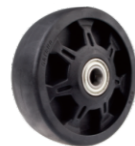
耐高温轮 采用特殊工程塑料模压而成，高强度、耐高温250°C和280°C。用于4系列。
