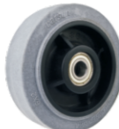
导电轮 超高强度塑料芯包热塑性超级人造胶，含导电材料具备良好的导电性能。用于4系列。
